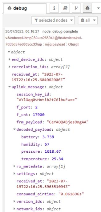
Ilustración 30: Información recibida por MQTT en Node-RED y mostrada por el primer nodo "debug"
