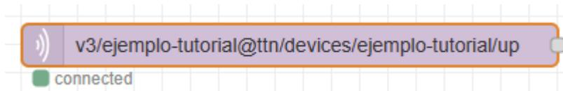
Ilustración 29: Nodo *mqtt in* conectado correctamente a la integración MQTT de TTN
